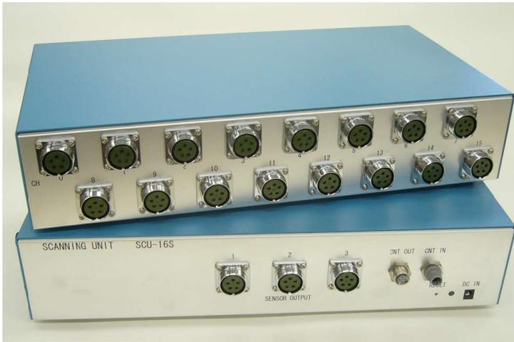
本製品は弊社のデータ集録装置(JASS-412B)にSCU ADAPTER(SCA-M1)を接続して使用する専用製品です。計測システムにおいて、データ集録装置配下のSCU ADAPTERから出力されるセンサインターフェイス(RS-485)を本製品が受信し、該当するチャンネルを選択してセンサーの信号をデータ集録装置に送信します。
